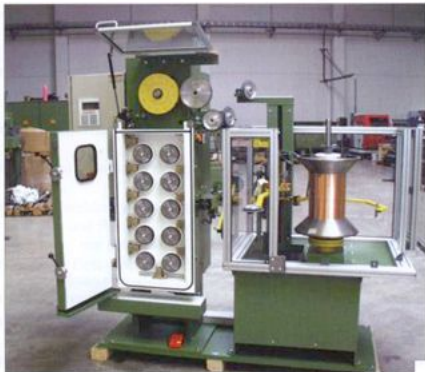
Ziehmaschine mit Wickler Drawing-Machine with Take-Up Type: DCI 11/5-360/1-15/5 + EWW 360-100/1-500x750/2
